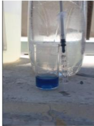
90 ppm de dureza, a la entrada de los suavizadores recién instalados
